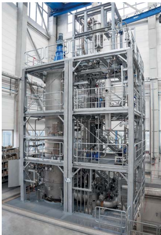
Fertig montierte Kurzwegdestillationsanlage vor der Auslieferung
